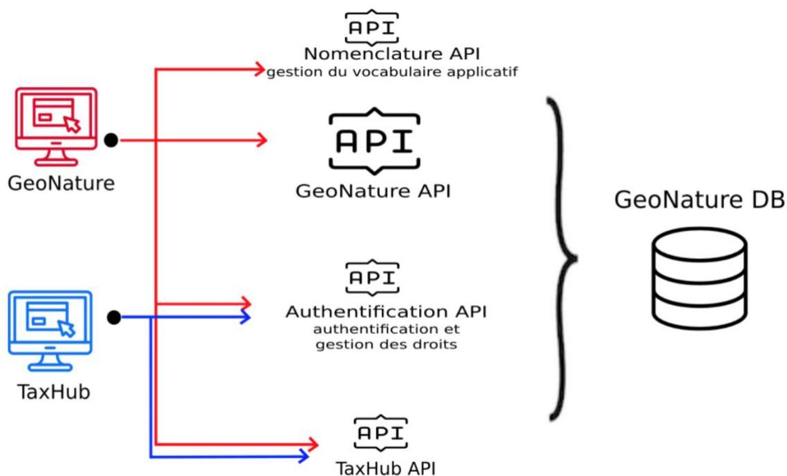
Geonature et Taxhub sont les deux applications indispensables dans une telle installation, et reposent bien sur une seule et même base de données. Les autres applications existantes le font également, mais n'étant pas forcément nécessaire à tout développement, ne sont pas sur ce schéma.
